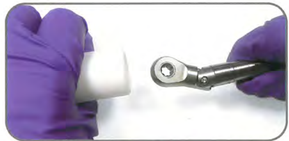
Um die Blockierung aufzuheben und die Ratsche wieder verwenden zu können, führt man diese in das Reaktivierungs-Kunststoffrohr ein.
